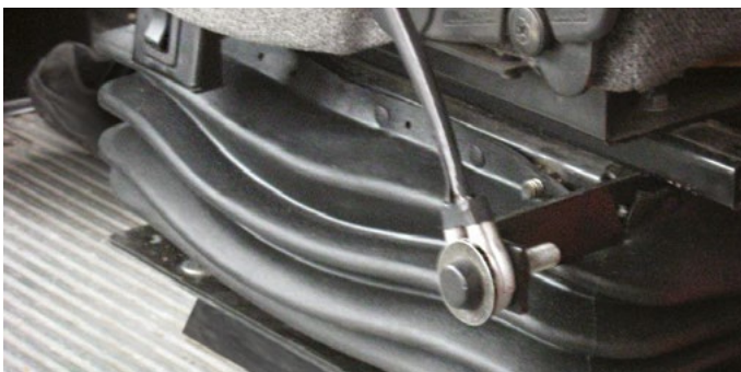
Soufflets du siège conducteur/ Bellows for driver's seat adjustment
