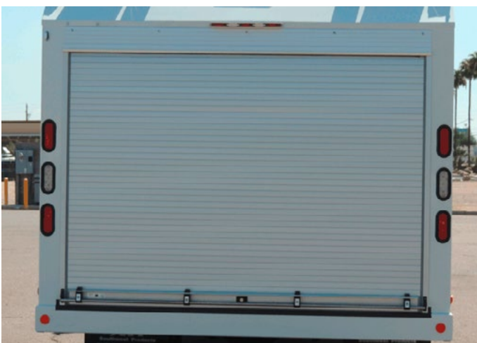
Portes roulantes pour salle de chargement/ Roll-up compartment doors
